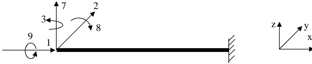
Şekil 2. Konsol bir kirişe uygulanan birim kuvvet yönleri
